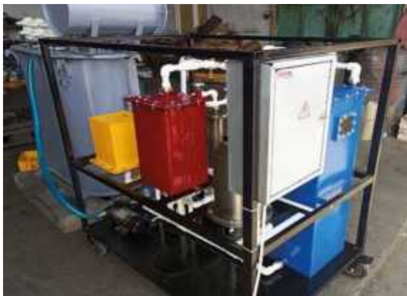
Процессы очистки отработанных трансформаторных масел на предприятии ООО “Зартрансформатор” с использованием разработанного отечественного мобильного устройства (Патент РУз № FAP 02334).
