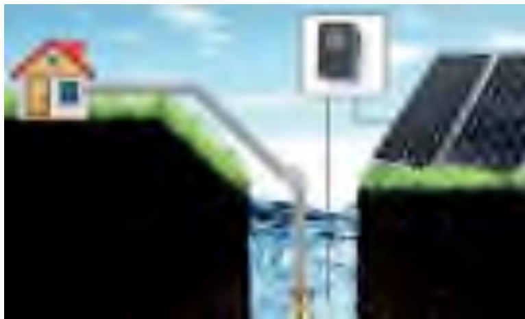
Quyosh energiyasida ishlaydigan suvko'targich
