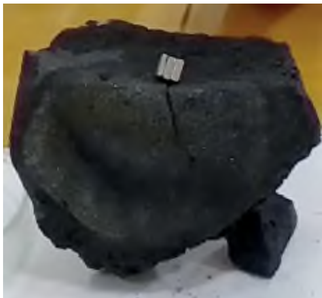
Массивный сверхпроводящий купрат висмута, синтезированный в Большой солнечной печи (Паркент) и его субмикронная слоистая структура
