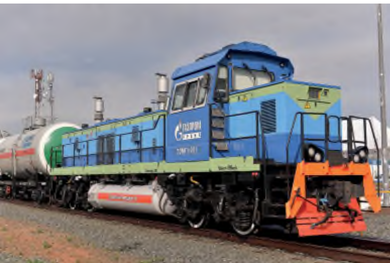
Газопоршневой маневровый локомотив ТЭМГ1 в Оренбургской области
