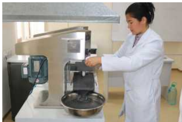
Процесс обогащения графитовой руды месторождения Тасказган в лабораторных условиях
