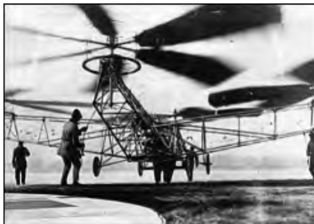
Jorj DeBotezat tomonidan ishlab chiqilgan kvadrokopter havoda ikki daqiqa 45 soniyadan keyin Makkuk maydoniga tushadi. Edison milliy tarixiy saytining arxividan olingan fotosurat.
