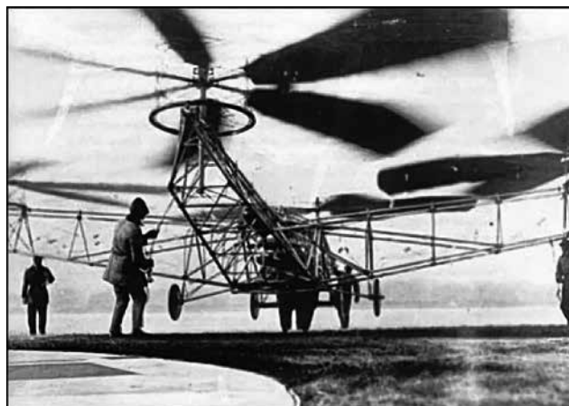
Квадрокоптер, разработанный Джорджем Де Ботезатом, совершает спуск на поле Маккук после двух минут 45 секунд пребывания в воздухе. Фотография из архива Национального исторического сайта Эдисона.
