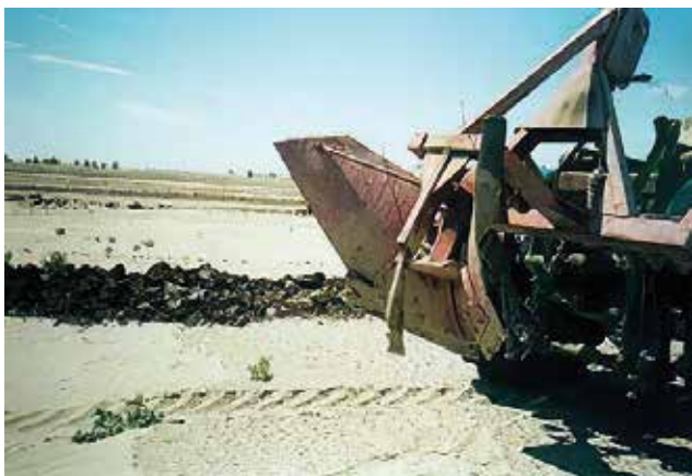
Механический агрегат с щелевателем для нарезки борозд
