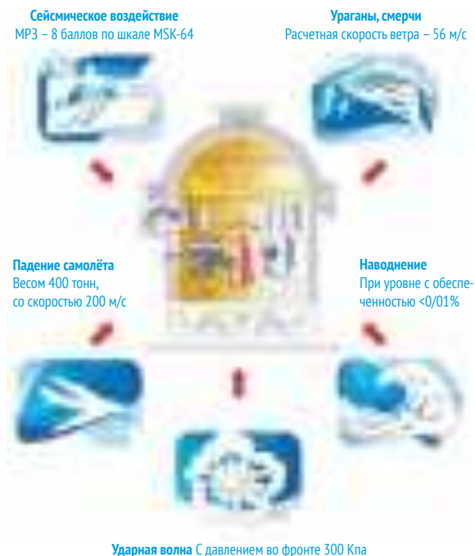
Рис. 4. Устойчивость энергоблока АЭС к внешним воздействиям
