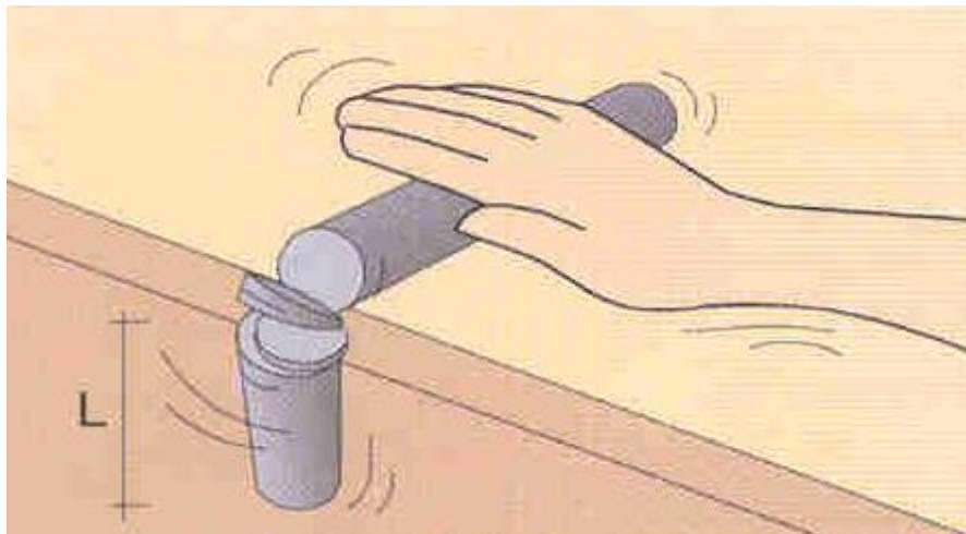
2.1-расм. Грунт материалларини ва улардан маҳсулот ишлаб чиқаришда фойдаланиладиган қоришманинг пластиклигини текшириш учун тест ўтказилиши
